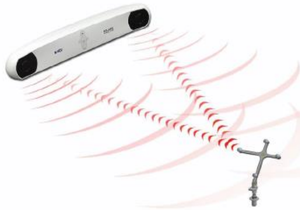
Fig. 1 Princípio de operação da câmera Polaris Spectra
