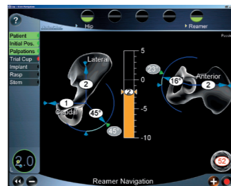
Fresagem navegada do acetábulo.
